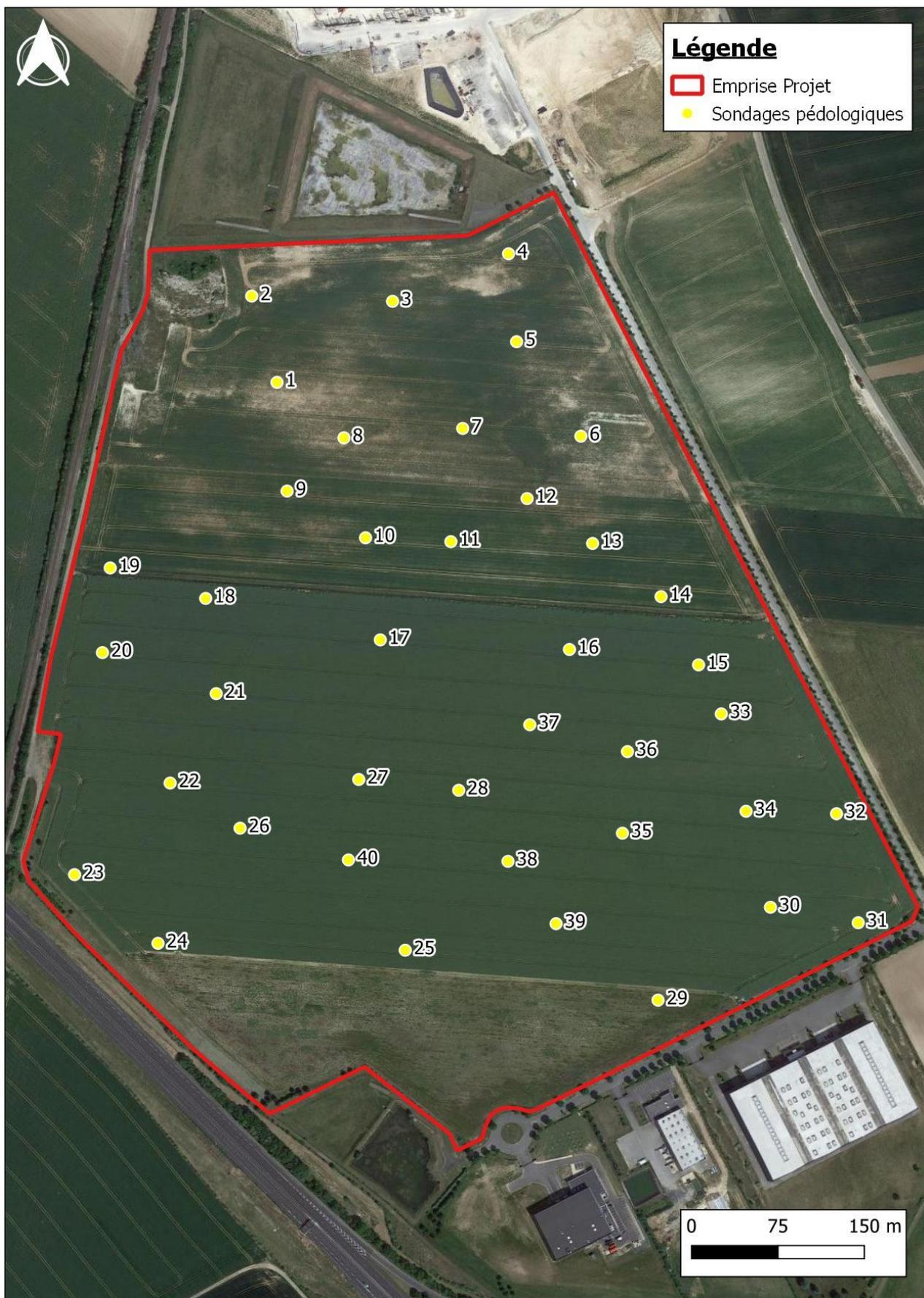
Figure 13 : Localisation des sondages pédologiques réalisés à la tarière manuelle
